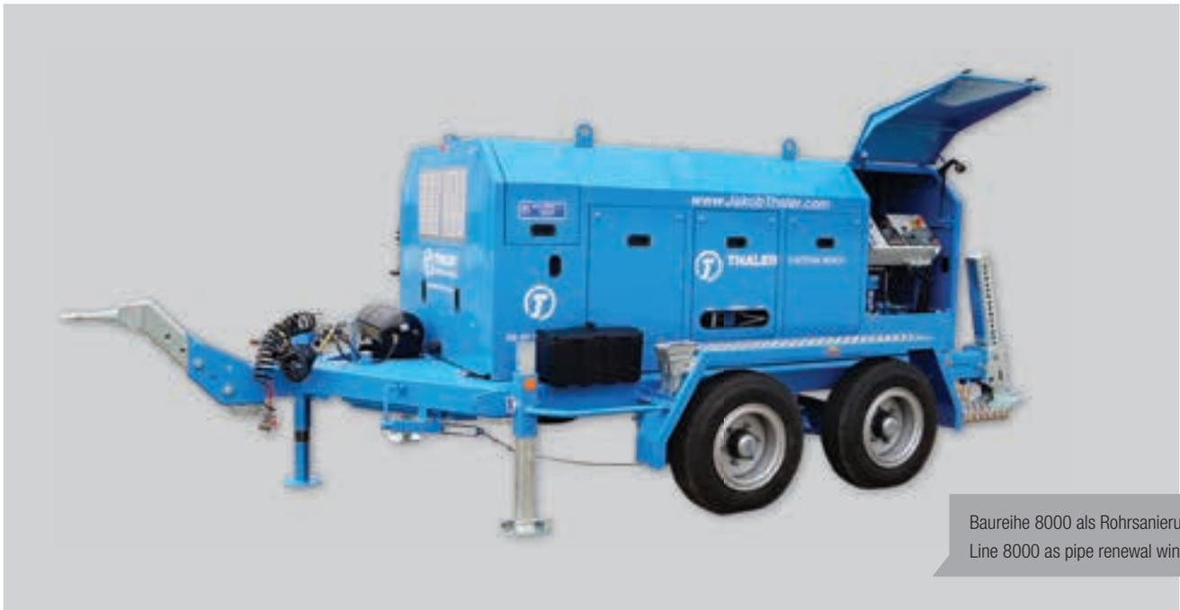
Baureihe 8000 als Rohrsanierungswinde
