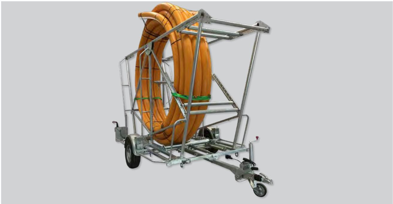
Der Anhänger wird in zwei Gewichtsklassen gefertigt. Als Typ **RVL 916** mit einer Zuladung von 900 kg und **RVL 1616** mit einer Zuladung von 1400 kg können die Fahrzeuge Rohrbünde mit einem max. Durchmesser von 180 mm und einer Länge von 100 Metern transportieren.
